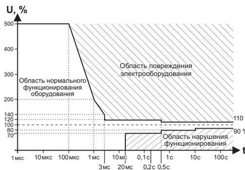
Рис. 1. Кривая работы электрооборудования ITIC (CBEMA), ([http://www.home.agilent.com/upload/cm\\_upload/All/1.pdf?&cc=UA&c=eng](http://www.home.agilent.com/upload/cm_upload/All/1.pdf?&cc=UA&c=eng)).
