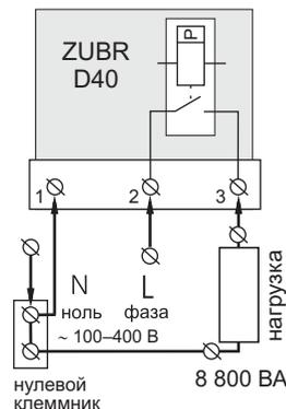
Схема 1. Упрощенная внутренняя схема и схема подключения
