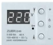
При включении, устройство сразу начинает отображать значение напряжения сети. Если напряжение находится в допустимых пределах, включается нагрузка и начинает светиться зеленый светодиод. Если напряжение сети превышает верхний предел или ниже нижнего предела, тогда напряжение на нагрузку не подается.
